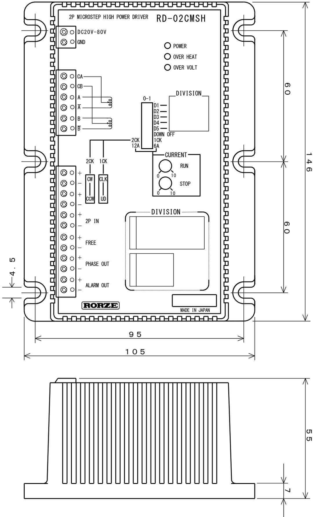
第15圖 RD-02CMSH外形寸法圖 單位 (mm)
