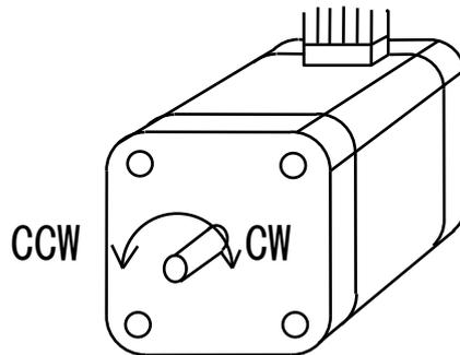
第5図 ステッピングモータ回転方向
