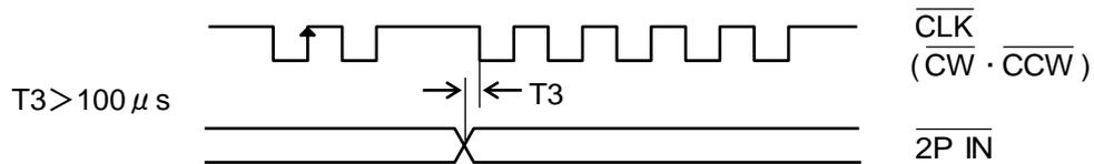
注1 この図は、外部電源を各“+”端子へ、外部コントローラのオープンコレクタ出力を“-”端子へ接続した場合の、“-”端子の電圧波形(負論理)です。
